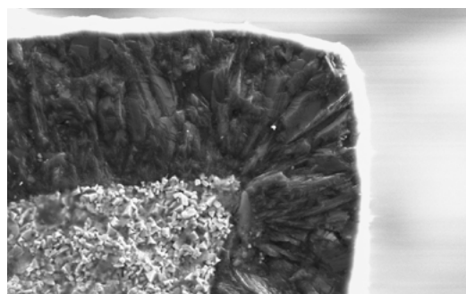
Espessura uniforme do revestimento ao longo de todo o comprimento da aresta de corte
